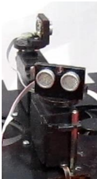
شکل ۳-۴ پیاده‌سازی قرارگرفتن حسگرهای فراصوت بر روی سرو، هر یک از حسگرهای فراصوت بر روی یک محفظه‌ی تفلونی قرارگرفته‌اند و بر روی ربات نصب شده‌اند.
